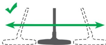
Важно держать поисковую катушку параллельно земле, чтобы получить точные результаты.
