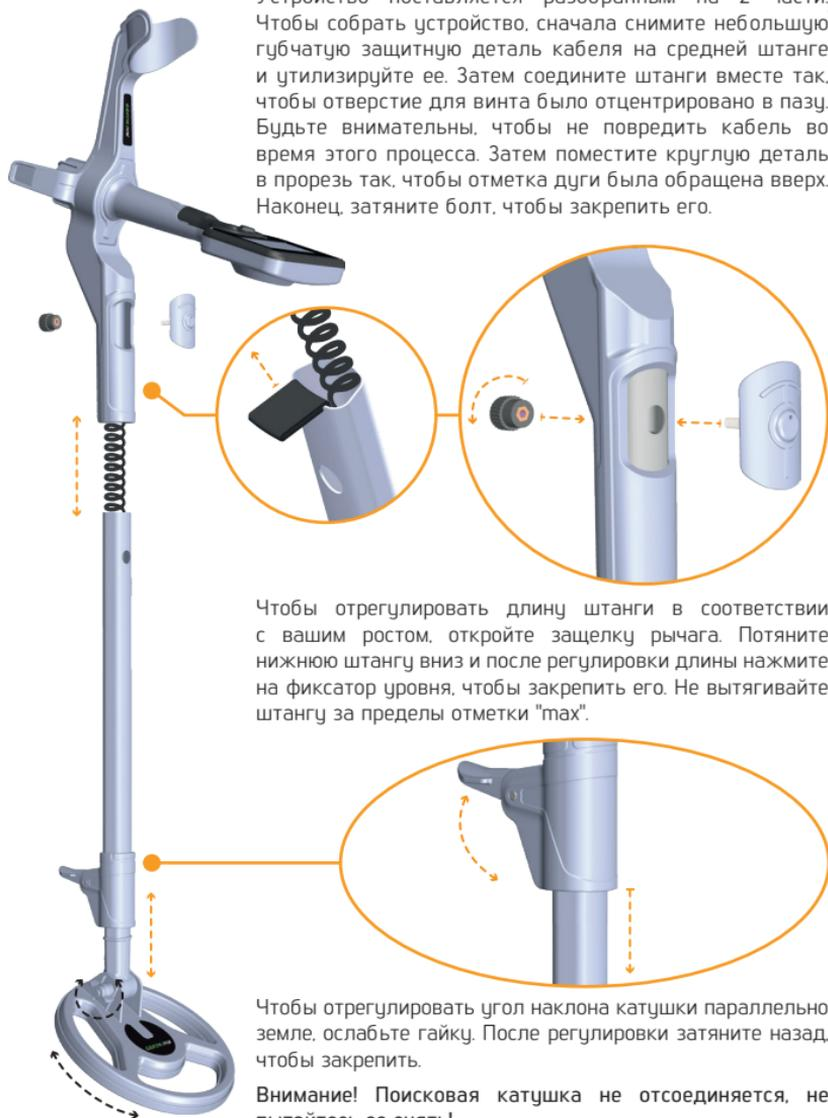
Чтобы отрегулировать длину штанги в соответствии с вашим ростом, откройте защелку рычага. Потяните нижнюю штангу вниз и после регулировки длины нажмите на фиксатор уровня, чтобы закрепить его. Не вытягивайте штангу за пределы отметки "max".
