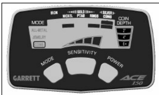
1. Кнопка **POWER (ПИТАНИЕ)** – чтобы включить (ON) или выключить (OFF) детектор, нажмите на кнопку POWER один раз. Примечание: После выключения детектора подождите 3-5 секунд, прежде чем включить прибор снова.
