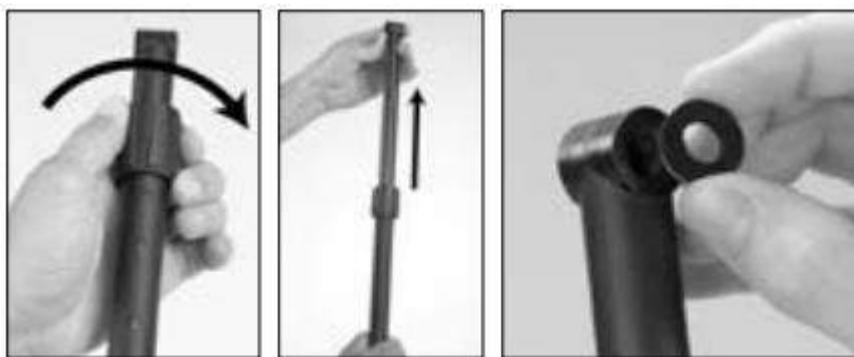
Ослабьте крепление верхнего эксцентрикового зажима, вставьте S-образную штангу с блоком управления, отрегулируйте длину нижней штанги и затяните зажимы вручную. Плотно обмотайте кабель вокруг штанги, сделав первый виток кабеля поверх штанги.
